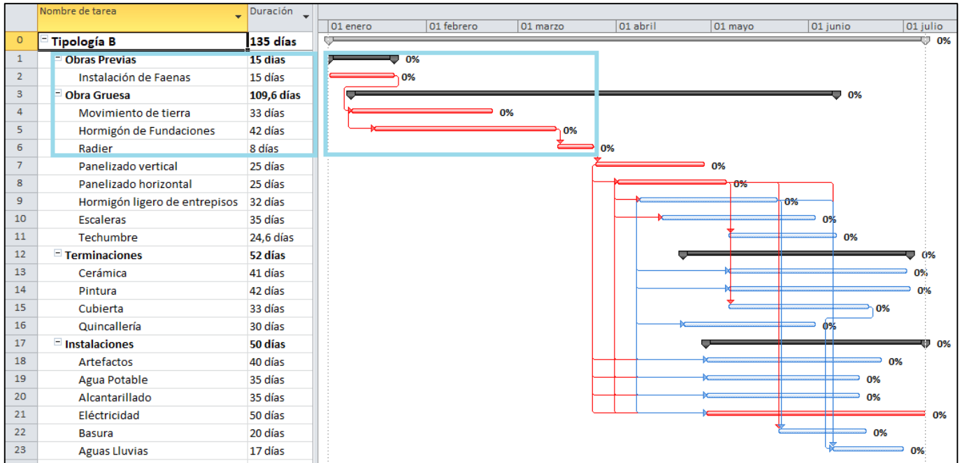
Figura 4: Programación de obra vivienda emergente
